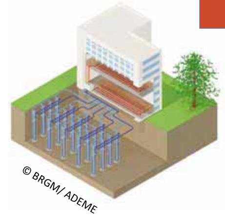
PAC géothermique sur champ de sondes
