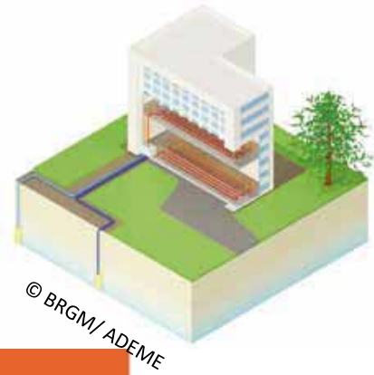
PAC géothermique sur nappe
